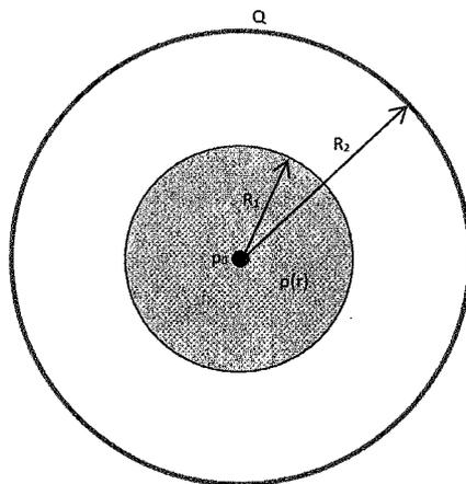
Gegeben ist die oben abgebildete radialsymmetrische Ladungsverteilung. Sie ist aufgebaut aus einer Punktladung  $\rho_0$  im Zentrum. Umgeben wird diese Punktladung von einer Kugel mit Radius  $R_1$  und einer vom Radius abhängigen Ladungsverteilung  $\rho(r) = \beta \left( \frac{1}{r^2} - \frac{\alpha}{r} \right) e^{-\alpha r}$ . Um diese Kugel ist noch eine infinitesimal dünne Kugelschale mit Radius  $R_2$  angebracht, auf der sich eine Gesamtladung  $Q$  befindet, die homogen verteilt ist.
